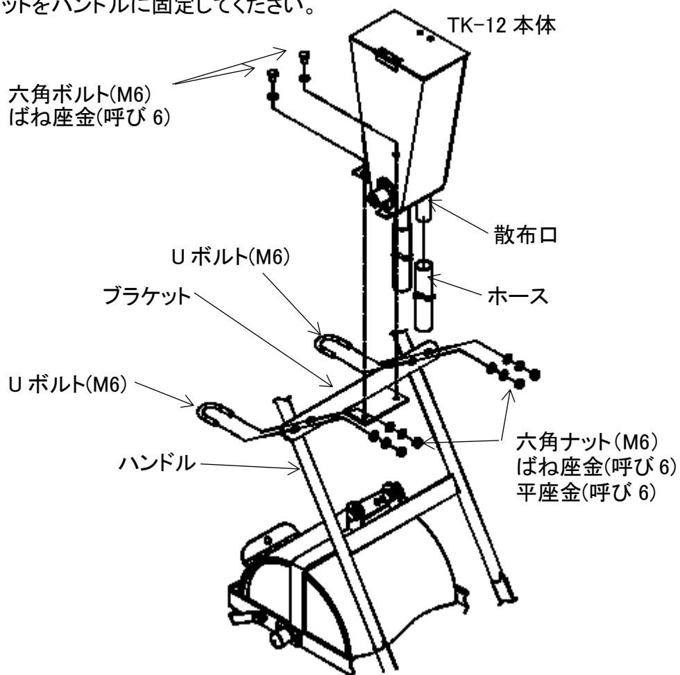
④ホースの反対側を図のように TK12 用ホースガイドセットに固定してください。
