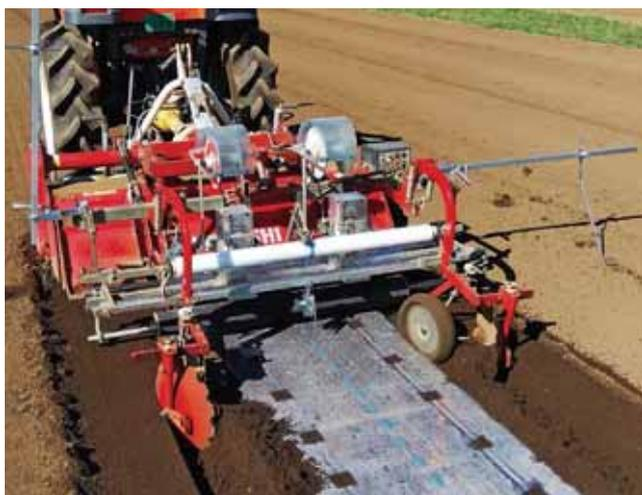
特 徴 ・同時穴開けマルチ施工をしながら次畦に目印を付けていきます。
